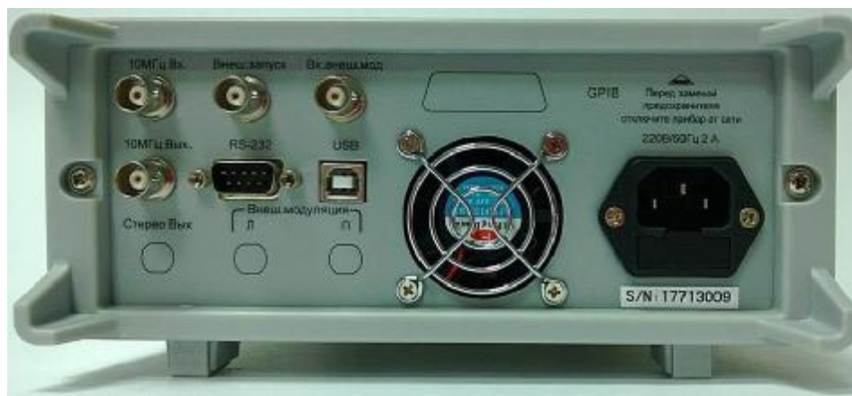
Рисунок 4 – Вид задней панели генератора АК ИП-3410
